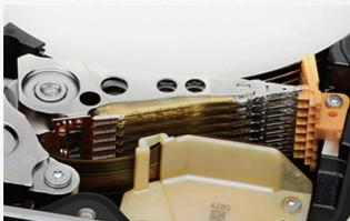
ULTRASTARハードディスクドライブは、デスクトップ用ドライブの最大10倍のワークロード率を発揮し、エンタープライズクラスの高い信頼性、電力効率、パフォーマンスを実現する高度なテクノロジーを導入しています。このシリーズは、1段目で大まかな位置決めを行い、2段目で、ピエゾ素子の変位を利用してヘッドの位置決めを高精度に微調整するシステムにより、高い精度を確保しています。
