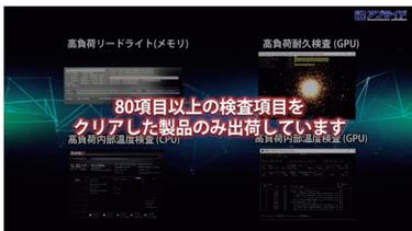
アプライドの国内自社工場で生産されるパソコンはすべて、業界標準検査の「Quick Tech Professional」による診断を行っています。CPU、Memory、HDDなどコンピュータを構成する各ハードウェアに対し、実際に稼動しているときと同じ状態を作りだし、負荷をかけます。それぞれのハードウェアに対し、個別の強力な診断プログラムが用意されています。(※例えば、メモリの診断では定評あるメモリ診断アルゴリズム「Jump」をはじめ、6種類の診断アルゴリズムを駆使してエラーを検出します。) こうして、ソフトウェア的に負荷をかけることにより、従来の診断ツールでは発見できなかったエラーの検出も可能になりました。この「Quick Tech Professional」で診断された結果を「診断書」として製品に添付いたします。これが、「品質合格の証」です。
